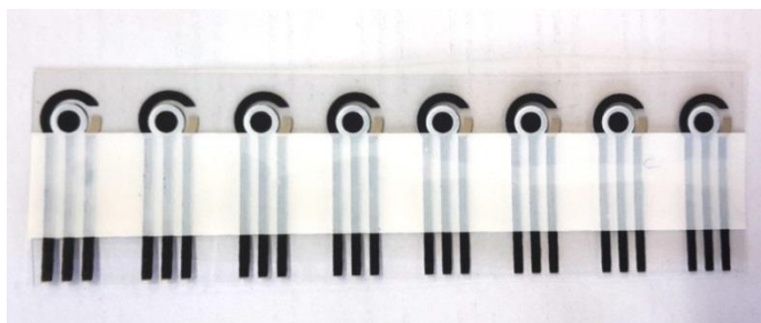
Fig.21 Elettrodi stampati (SPE) presso i Laboratori di Chimica Analitica dell'Università di Roma Tor Vergata.
