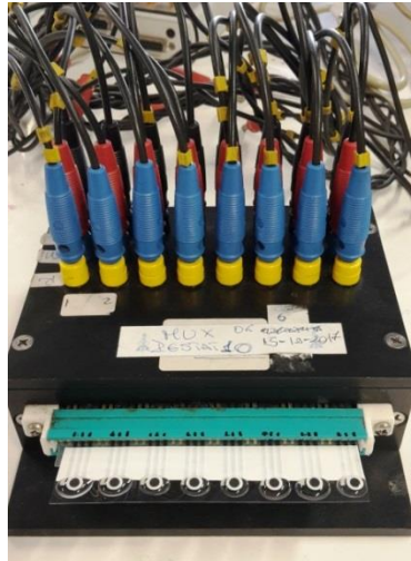
Fig.22 Connettore Mux-8 con striscia composta da 8 SPE.
